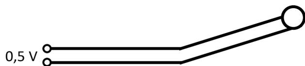
An die Schiene wurde mit einem Labornetzgerät eine konstante Spannung von  $0,50 \text{ V}$  angelegt und die Stromstärke gemessen. Befindet sich die Kugel in der Startposition, wird eine Stromstärke von  $I_1 = 10,0 \text{ A}$  gemessen. Legt man die Kugel dagegen genau in die Knickstelle zur Waagerechten, erhält man eine Stromstärke von  $I_2 = 25,0 \text{ A}$ . Rollversuche ergaben, dass die Kugel die Beschleunigungsstrecke in  $t = 3,50 \text{ s}$  zurücklegt.
