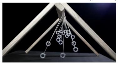
nach  $T_{max}$  wieder seinen Ausgangszustand erreicht hat, so muss diese Zeit ein ganzzahliges Vielfaches der Periodendauer sein. Wenn ein anderes Pendel in der gleichen Zeit eine Periode mehr durchlaufen hat, wird es nach dieser Zeit ebenfalls seinen Ausgangszustand erreichen. Max besitzt einen Holzrahmen, der eine maximale Pendellänge für das 1. Pendel von 230 mm erlaubt.  $T_{max}$  legt er willkürlich mit 24 s fest.
